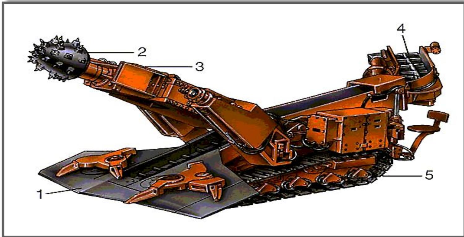
Горный комбайн проходческий: 1 — погрузочный стол; 2 — фрезерная коронка; 3 — стреловидный исполнительный орган; 4 — перегружатель; 5 — ходовая часть.
