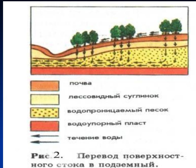
Рис. 2. Перевод поверхностного стока в подземный.
