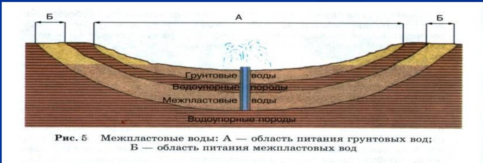
Рис. 5 Межпластовые воды: А — область питания грунтовых вод;
