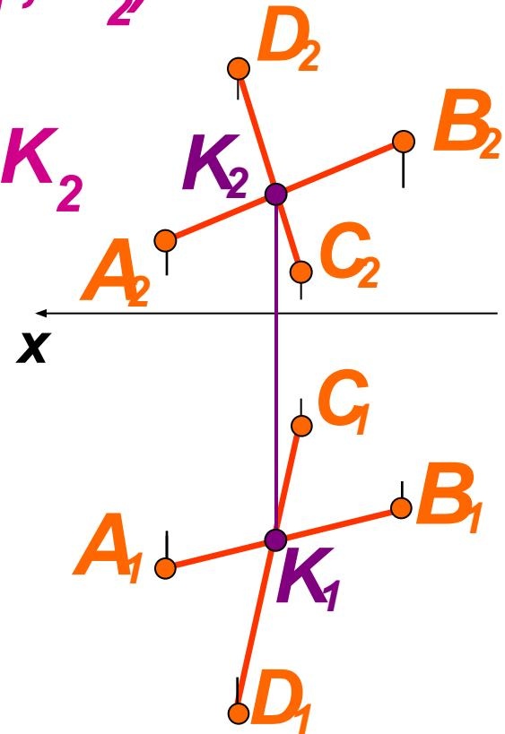
Точка пересечения  $K$  прямых  $AB$  и  $CD$  проецируется в точки пересечения соответствующих проекций прямых: на  $\Pi_1$  - это точка  $K_1$ ; на  $\Pi_2$  - точка  $K_2$ . Точки пересечения  $K_1$  и  $K_2$  одноименных проекций прямых лежат на одной линии связи
