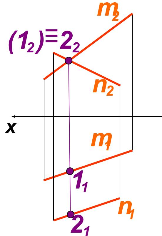
Проекции скрещивающихся прямых могут быть параллельны, т.к. прямые  $m$  и  $n$  лежат в параллельных плоскостях. Проекции скрещивающихся прямых могут иметь пересечение, т.к. прямые  $m$  и  $n$  не параллельны между собой. 1 и 2 – конкурирующие точки,
