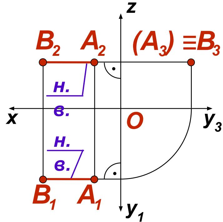
Прямая перпендикулярна  $\Pi_3$ , ее профильная проекция  $A_3B_3$  вырождается в точку. Относительно  $\Pi_1$  и  $\Pi_2$  прямая параллельна, на этих плоскостях ее проекции имеют натуральную величину. Горизонтальная и фронталь-ная проекции прямой перпендикулярны осям
