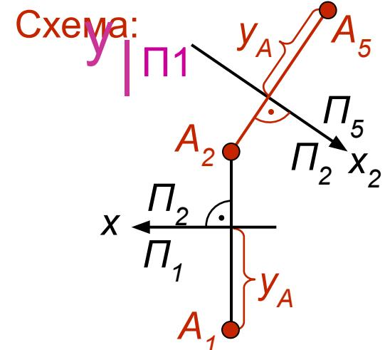
Заменим исходную горизонтальную плоскость проекций  $\Pi_1$  на новую плоскость проекций  $\Pi_5$ , которой прямая  $AB$  будет параллельна. При этом преобразовании расстояние точек от плоскости  $\Pi_2$  (координата  $y$ ) остается неизменным
