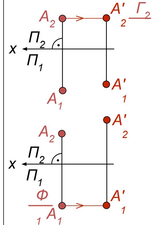
Для перевода прямой в положение горизонтали фронтальную проекцию прямой ( $A_2'B_2'' \equiv A_2B_2$ ) располагают параллельно оси х. Новые проекции точек  $A_1$  и  $B_1''$  расположены на соответствующих следах фронтальных плоскостей уровня  $\Phi(\Phi_1)$  и  $\Phi(\Phi_1')$ . На  $\Pi_1$  имеем н.в. отрезка и угла  $\beta$
