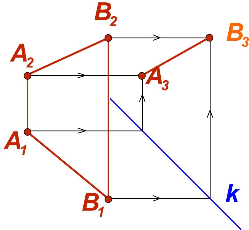
На чертеже проекции отрезка прямой общего положения имеют искаженные метрические характеристики, ни одна из ее проекций не параллельна осям координат и не перпендикулярна к ним
