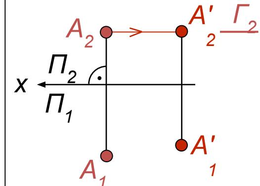
Данный отрезок  $AB$  занимает общее положение, преобразуем его во фронтальную прямую уровня путем перемещения концов отрезка по горизонтальным плоскостям уровня согласно схемы
