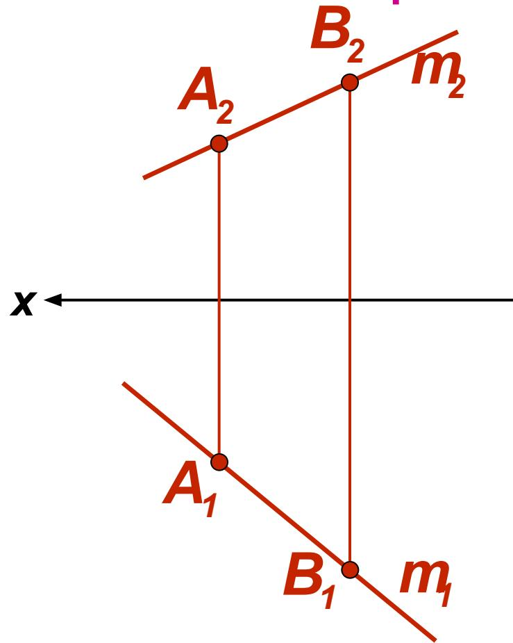
Проекции прямой  $m$  проходят через пары соответствующих проекций точек: горизонтальная проекция прямой  $m_1$  – через  $A_1$  и  $B_1$ ; фронтальная проекция прямой  $m_2$  – через  $A_2$  и  $B_2$
