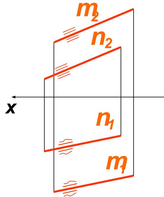
Проекции параллельных прямых не пересекаются. Одноименные проекции прямых параллельны или совпадают, если параллельные прямые лежат в проецирующей плоскости
