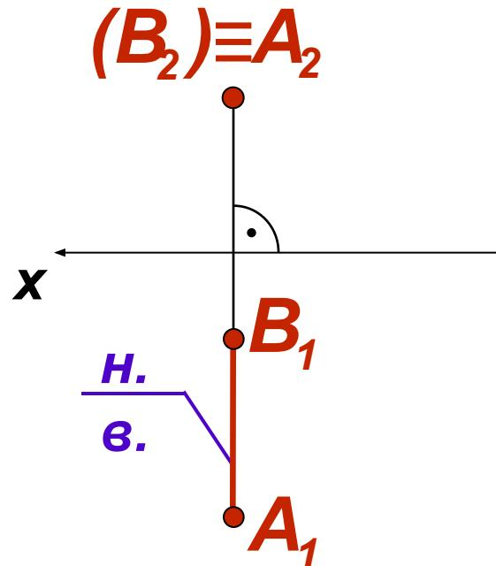
Прямая перпендикулярна фронтальной плоскости проекций  $\Pi_2$  и параллельна  $\Pi_1$  и  $\Pi_3$ . Фронтальная проекция  $A_2B_2$  вырождается в точку. На  $\Pi_1$  и  $\Pi_3$  прямая проецируется в натуральную величину. Проекция  $A_1B_1$  перпендикулярна оси координат x
