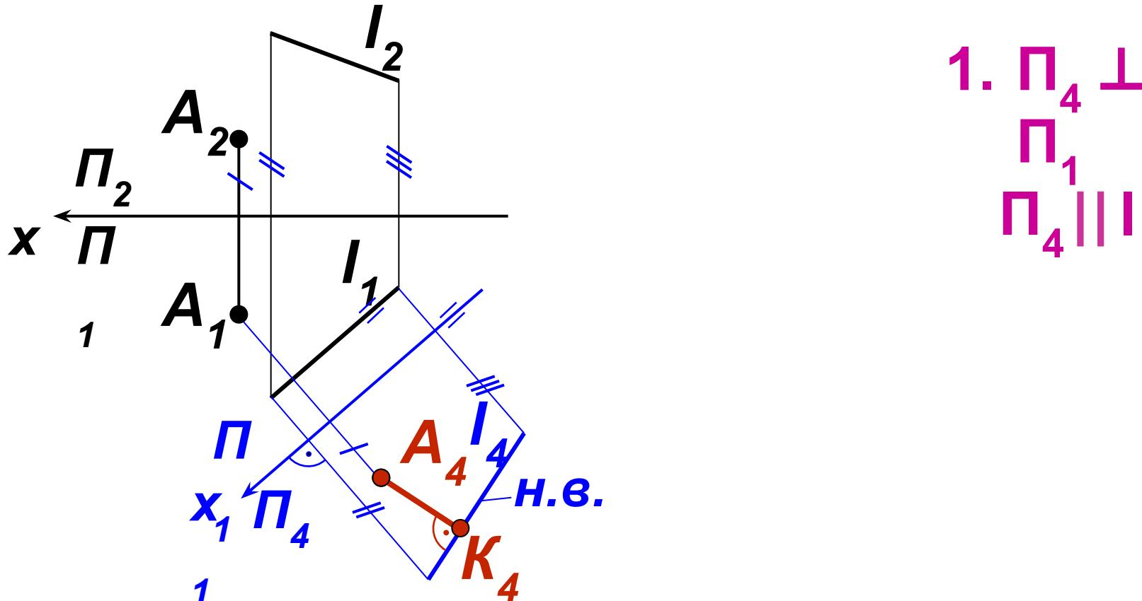
Искомое расстояние есть перпендикуляр. Введем новую плоскость проекций  $\Pi_4$  параллельно прямой  $l$  так, чтобы прямая заняла частное положение уровня. По теореме о проецировании прямого угла проекция искомого расстояния  $A_4K_4 \perp l_4$  определяется на плоскости проекций  $\Pi_4$
