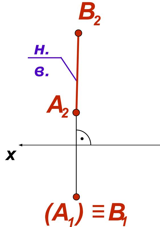
Прямая перпендикулярна  $\Pi_1$ , поэтому ее горизонтальная проекция  $A_1, B_1$  вырождается в точку. Относительно  $\Pi_2$  и  $\Pi_3$  прямая параллельна и изображается на этих плоскостях проекций в натуральную величину. Проекция  $A_2 B_2$  перпендикулярна оси координат  $x$
