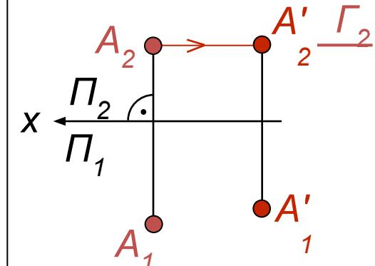
Горизонтальную проекцию прямой ( $A_1B_1' \equiv A_1B_1$ ) располагают параллельно оси  $x$ . Фронтальную проекцию (определяющую н.в. отрезка и угла  $\alpha$ ) задают новые проекции точек  $A_2$  и  $B_2$ , расположенные на соответствующих следах горизонтальных плоскостей уровня  $\Gamma(\Gamma_2)$  и  $\Gamma(\Gamma_2)'$
