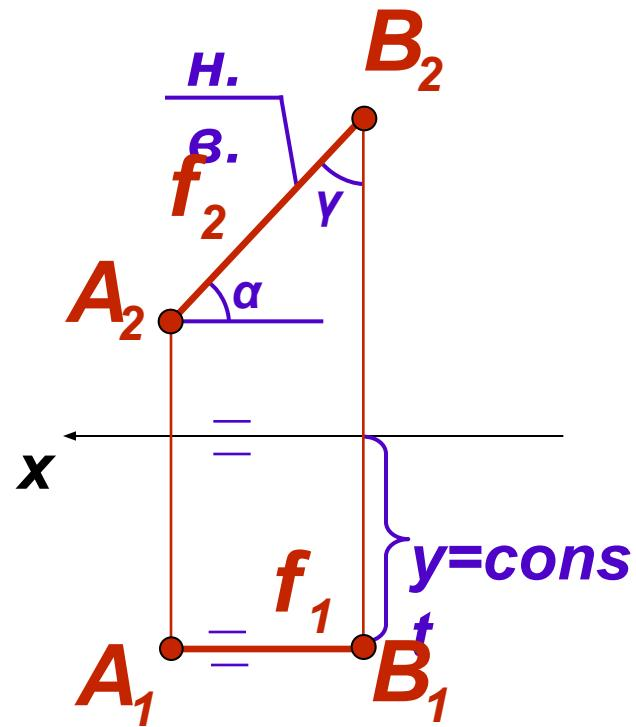
Все точки прямой  $AB$  равноудалены от фронтальной плоскости проекций  $\Pi_2$  и имеют одинаковую координату  $y$  ( $y = \text{const}$ ). Горизонтальная проекция фронтали  $A_1B_1$  параллельна оси  $x$ . Фронтальная проекция фронтали  $A_2B_2$ , углы  $\alpha$  и  $\gamma$  изображаются в натуральную величину на  $\Pi_1$ .
