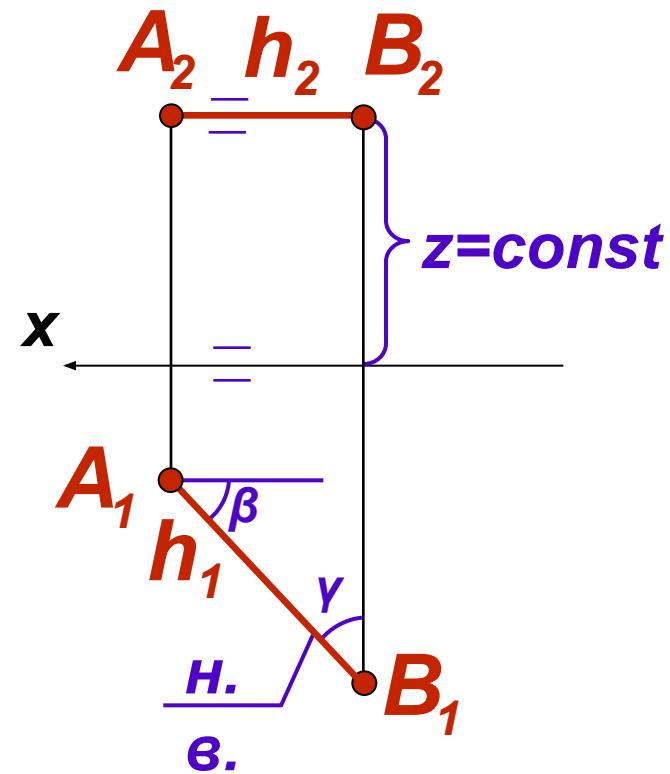
Все точки прямой  $AB$  равноудалены от горизонтальной плоскости проекций  $\Pi_1$  и имеют одинаковую аппликату  $z = const$ . Фронтальная проекция горизонтали  $A_2B_2$  параллельна оси  $x$ . Горизонтальная проекция горизонтали  $A_1B_1$ , углы  $\beta$  и  $\gamma$  изображаются в натуральную
