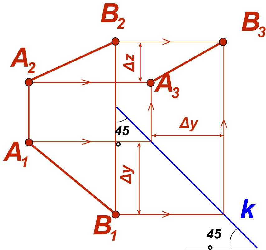
Для построения профильной проекции прямой на безосном чертеже проводят постоянную чертежа *k* под углом  $45^\circ$ . С ее помощью по линиям связи получают профильную проекцию прямой  $A_3 B_3$ , положение которой определяется разностями координат  $\Delta z$  и  $\Delta y$ .
