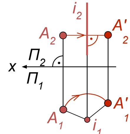
Для упрощения горизонтально-проецирующую ось вращения  $I$  проводят через точку  $B$ , которая остается неподвижной. Точка  $A_1$  описывает дугу окружности с центром в точке  $I_1$  так, чтобы  $B_1A_1 \parallel$  оси  $x$ . Тогда прямая  $AB$  займет положение фронтали. На  $\Pi_2$  угол  $\alpha$  и отрезок  $AB$  неискажаются
