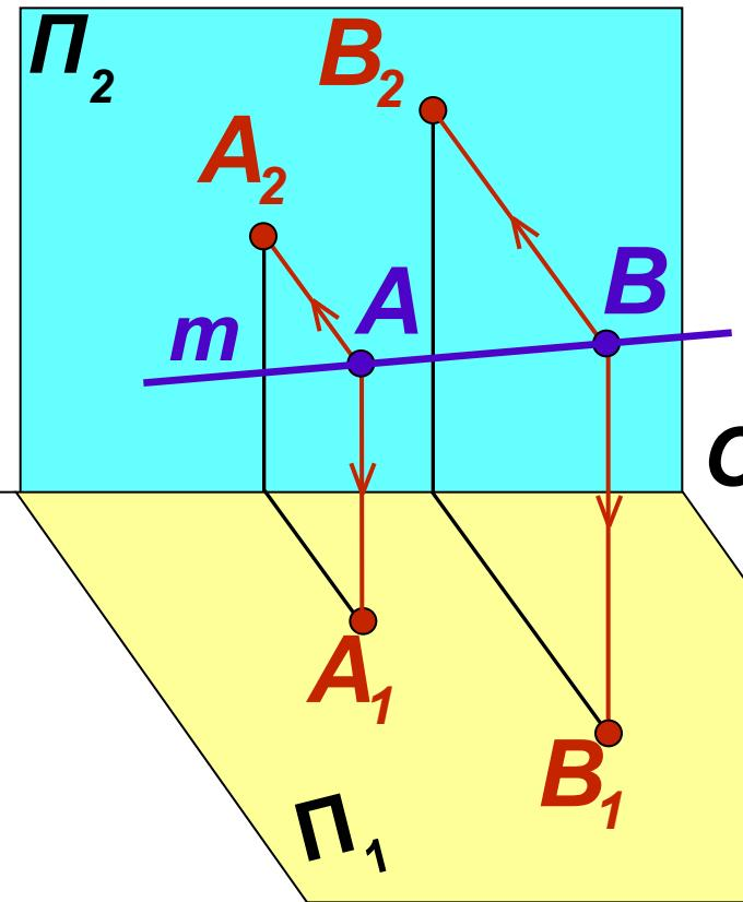
Положение прямой  $m$  в пространстве определяют две произвольные точки  $A$  и  $B$ , лежащие на этой прямой. Это наиболее удобный способ задания прямой. Прямая линия  $m$  считается заданной, если на комплексном чертеже построить проекции двух ее точек  $A$  и  $B$ .
