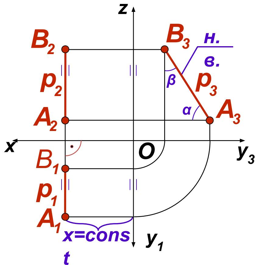
Все точки прямой  $AB$  равноудалены от профильной плоскости проекций  $\Pi_3$  и имеют одинаковую координату  $x$  ( $x = const$ ). Горизонтальная  $A_1B_1$  и фронтальная  $A_2B_2$  проекции прямой перпендикулярны оси  $x$ . Профиль-ная проекция  $A_3B_3$ , углы  $\alpha$  и  $\beta$  имеют натуральную величину
