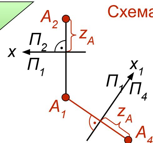
Заменим исходную фронтальную плоскость проекций  $\Pi_2$  на новую плоскость проекций  $\Pi_4$ , которой прямая  $AB$  будет параллельна. При этом преобразовании расстояние точек от плоскости  $\Pi_1$  (координата  $z$ ) остается неизменным
