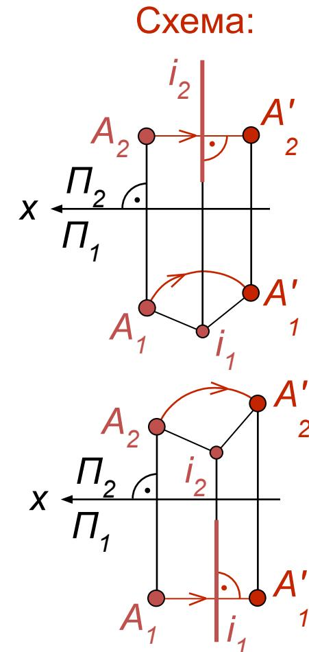
Для определения угла  $\beta$  прямую  $AB$  нужно вращать вокруг оси  $i \perp \Pi_2$  до положения горизонтали. Ось проходит через точку  $A$ , которая неподвижна. Точка  $B_2$  вращается по дуге окружности с центром в точке  $i_2$  до положения  $B_2$ .  $A_2 \parallel$  оси  $x$ . На  $\Pi_1$  угол  $\beta$  и отрезок  $AB$  не искажаются
