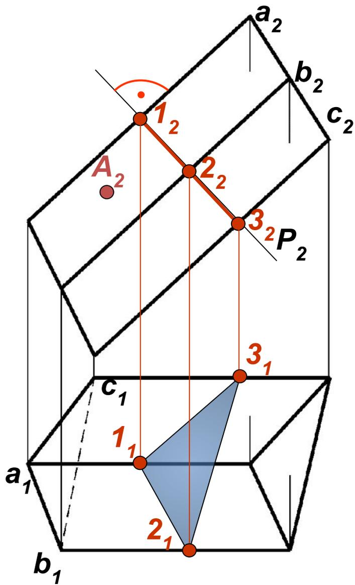
На  $P_2$  проводим след плоскости  $P_2$  перпендикулярно проекциям ребер - натуральным величинам. Для построения нормального сечения фиксируем точки пересечения следа  $P_2$  с проекциями ребер призмы как  $1_2$ ,  $2_2$  и  $3_2$ . Проекции  $1_1$ ,  $2_1$ ,  $3_1$  располагаем на  $a_1$ ,  $b_1$ ,  $c_1$  соответственно.
