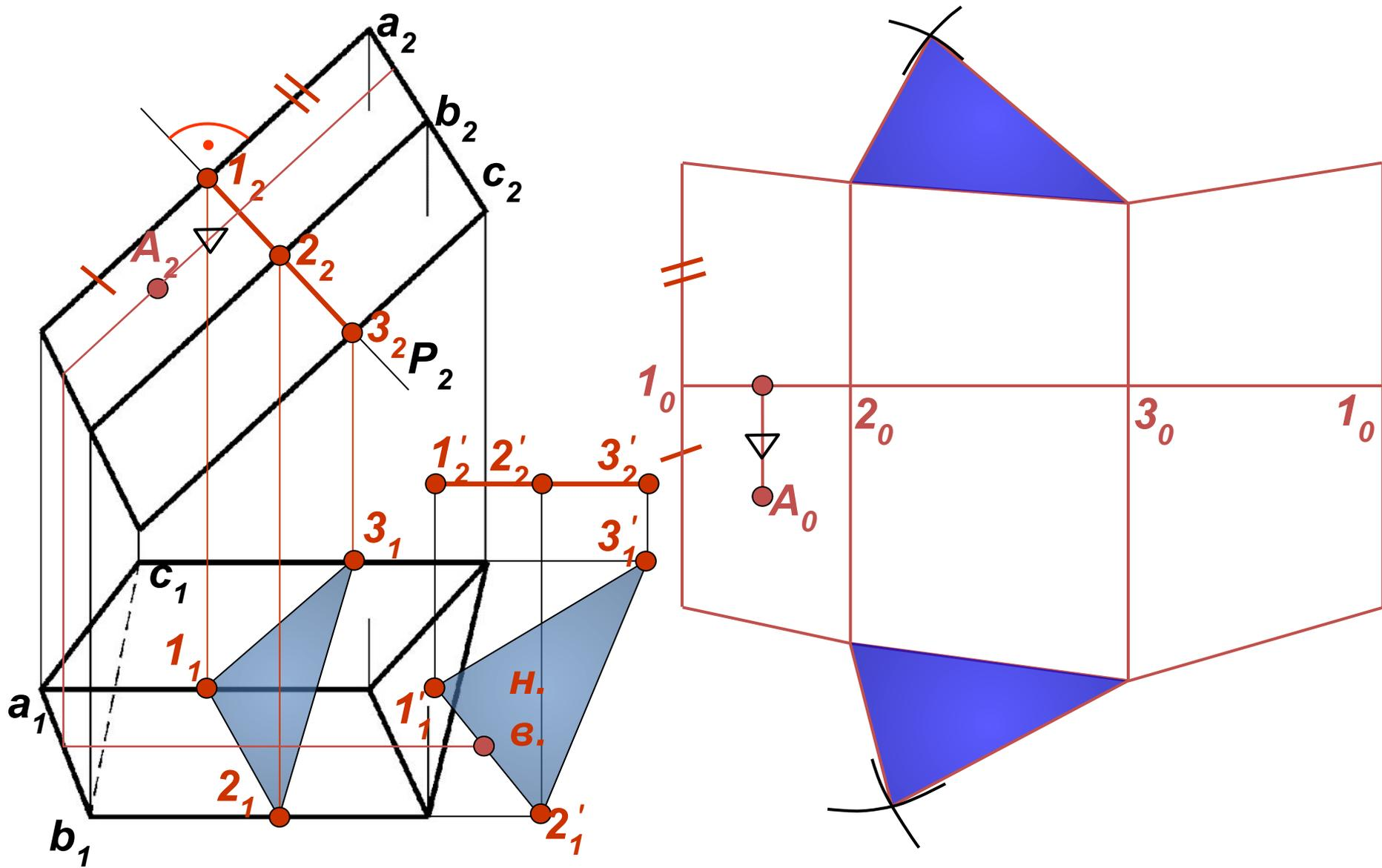
Точку  $A$ , заданную на поверхности, легко построить на развертке. Для этого на нужной грани через точку  $A$  проводим дополнительную прямую и, определив ее место на натуральной величине нормального сечения, находим расположение этой прямой вместе с точкой  $A_0$  на развертке.
