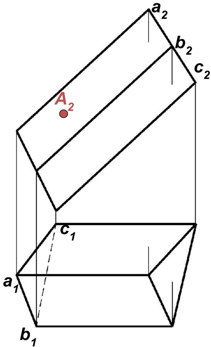
Боковые ребра призмы обозначены  $a$ ,  $b$  и  $c$ . На  $\Pi_2$  эти ребра имеют натуральную величину (являются фронталями). Поэтому след нормального сечения можно провести на исходном чертеже без его преобразования перпендикулярно проекциям - натуральным величинам ребер.
