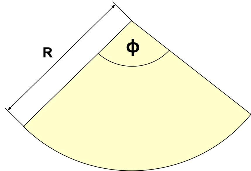
Для данных поверхностей строятся точные развертки. Боковая поверхность цилиндра – прямоугольник. Боковая поверхность конуса – круговой сектор
