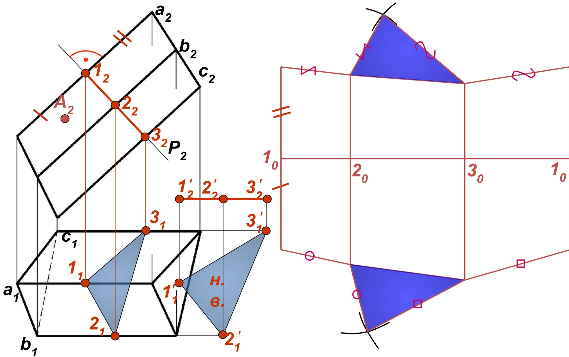
Достраиваем натуральные основания призмы способом засечек и получаем ее полную развертку.
