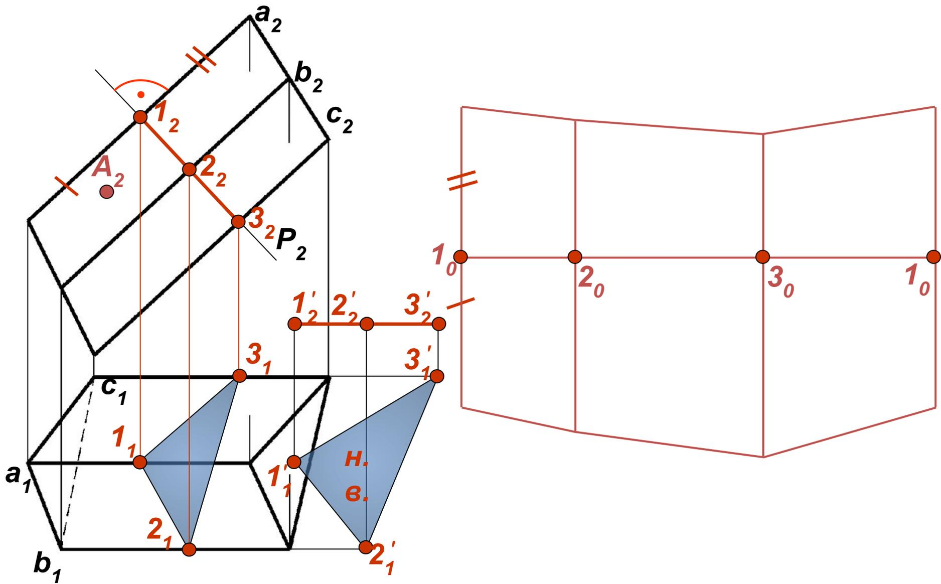
Развертку начинаем строить, развернув натуральное нормальное сечение в прямую линию с обозначением узловых точек  $1_0$ ,  $2_0$ ,  $3_0$  и еще раз  $1_0$ . Через узловые точки проводим натуральные ребра призмы перпендикулярно линии нормального сечения, перенеся равные отрезки ребер с  $\Pi_2$ .
