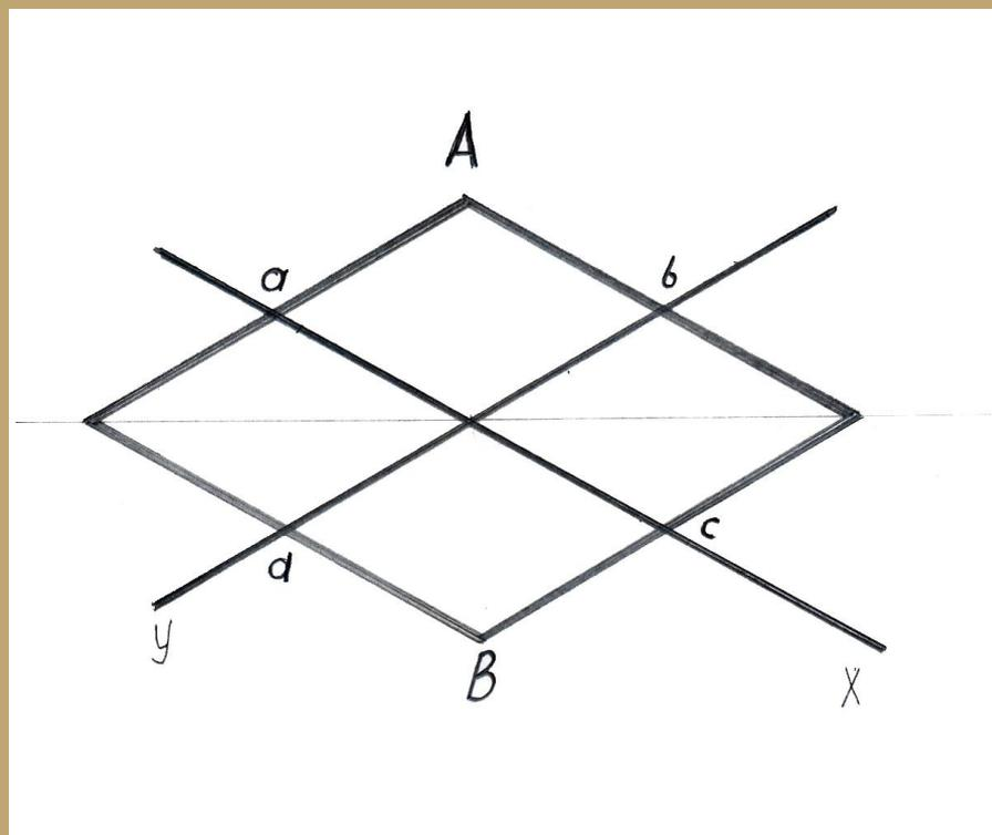
5. Из вершин  $A$  и  $B$  проводят дуги радиусом  $R = Ac = Ad = Ba = Bb$
