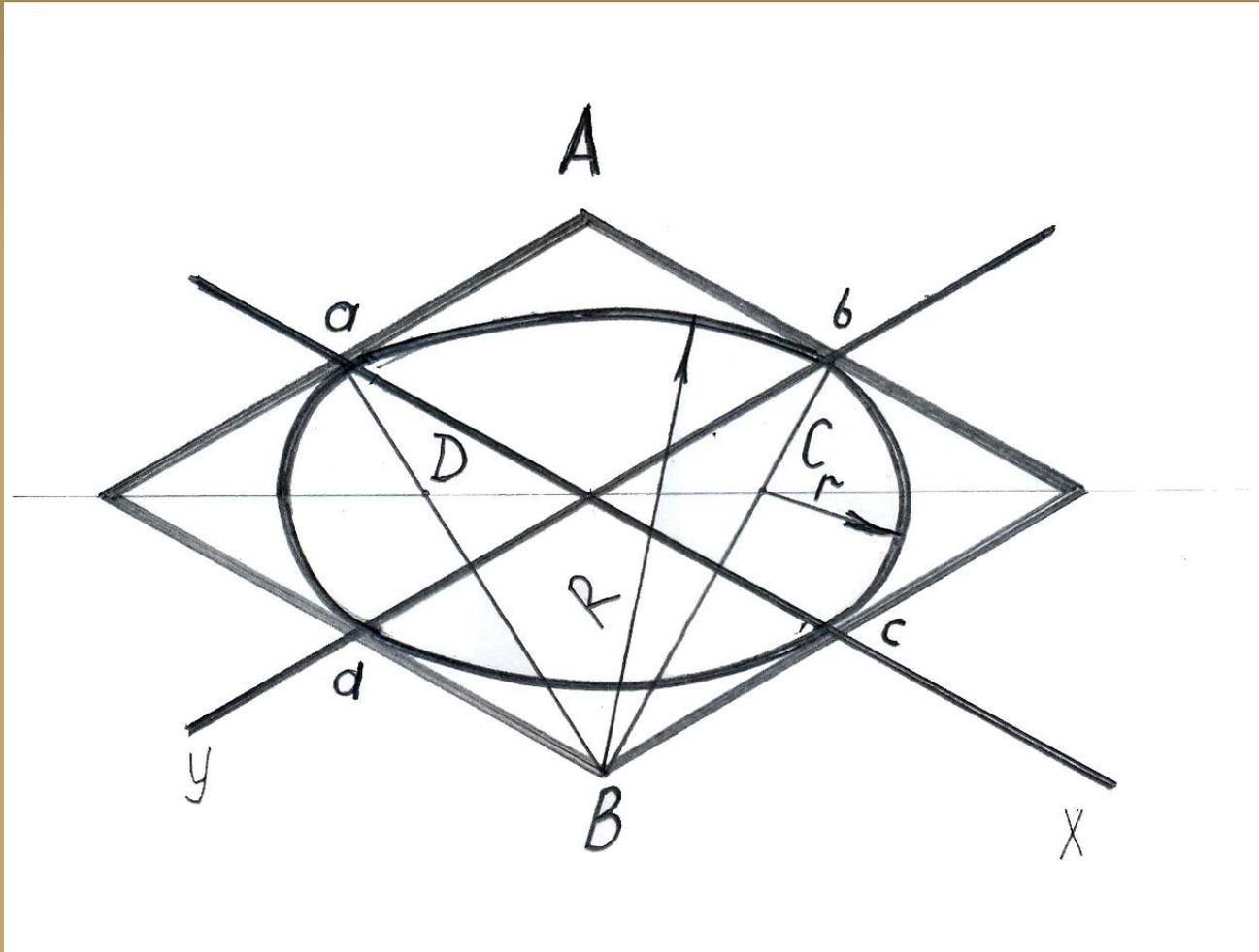
10. Начертите куб в изометрической проекции и впишите в каждый ромб овал
