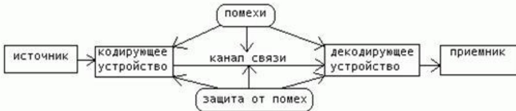
Рис. 3. Передача информации при наличии помех
