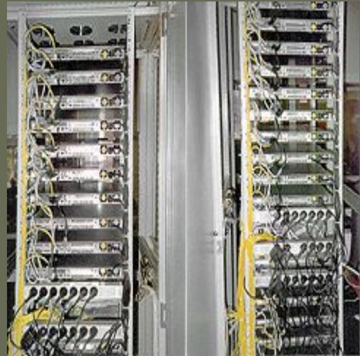
Кластер, собранный из 34 серверов серии R-Style Marshall
