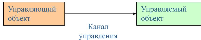
*Пример:* процесс записи информации на гибкий диск, где контроллер дисководов (управляющий объект) изменяет положение магнитной головки дисковода (управляемый объект)
