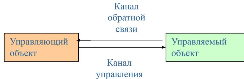
*Пример:* запись на жесткий диск, где контроллер жесткого диска (управляющий объект) по каналу обратной связи постоянно получает информацию о реальном положении магнитных головок (управляемый объект) и по каналу управления выставляет головки над поверхностью пластин с большой точностью.
