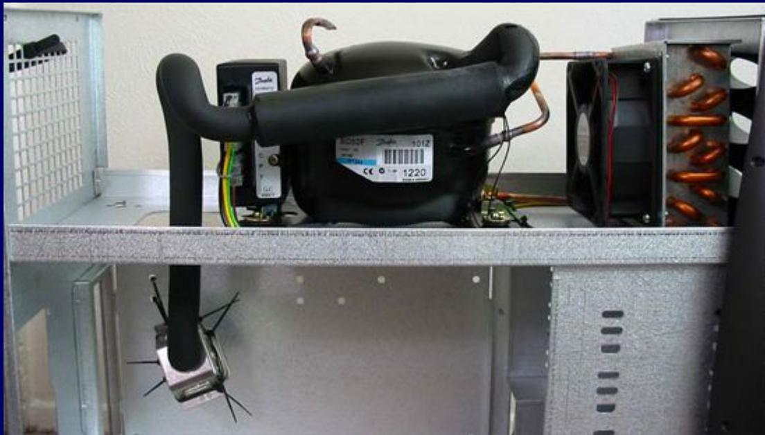
Эти системы отличаются от «водянок» только тем, что в качестве теплоносителя вместо воды используется «прирожденный» термальный агент — фреон. Соответственно, контур полностью и обязательно герметичен, а насос и теплообменник отличаются улучшенным качеством.
