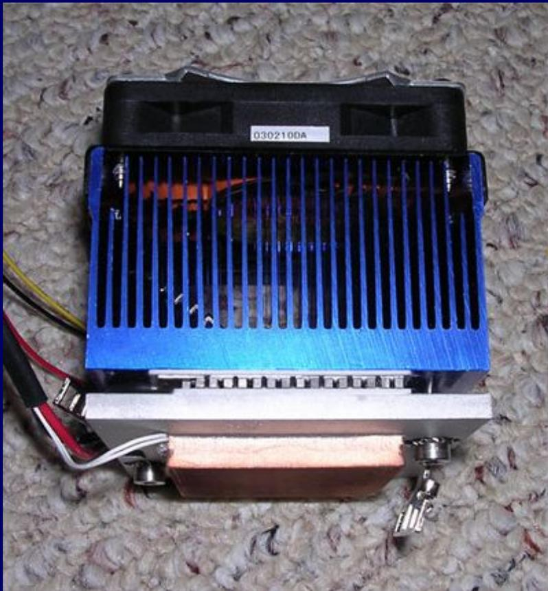
Элемент Пельтье — это небольшая пластинка, играющая роль «прокладки» между кристаллом процессора и кулером. Не вдаваясь в физические основы явления Пельтье, можно отметить, что эта пластинка позволяет поддерживать разность температур сторон пластинки в районе  $40^{\circ}\text{C}$  при отдаваемых кристаллом процессора десятках ватт тепла
