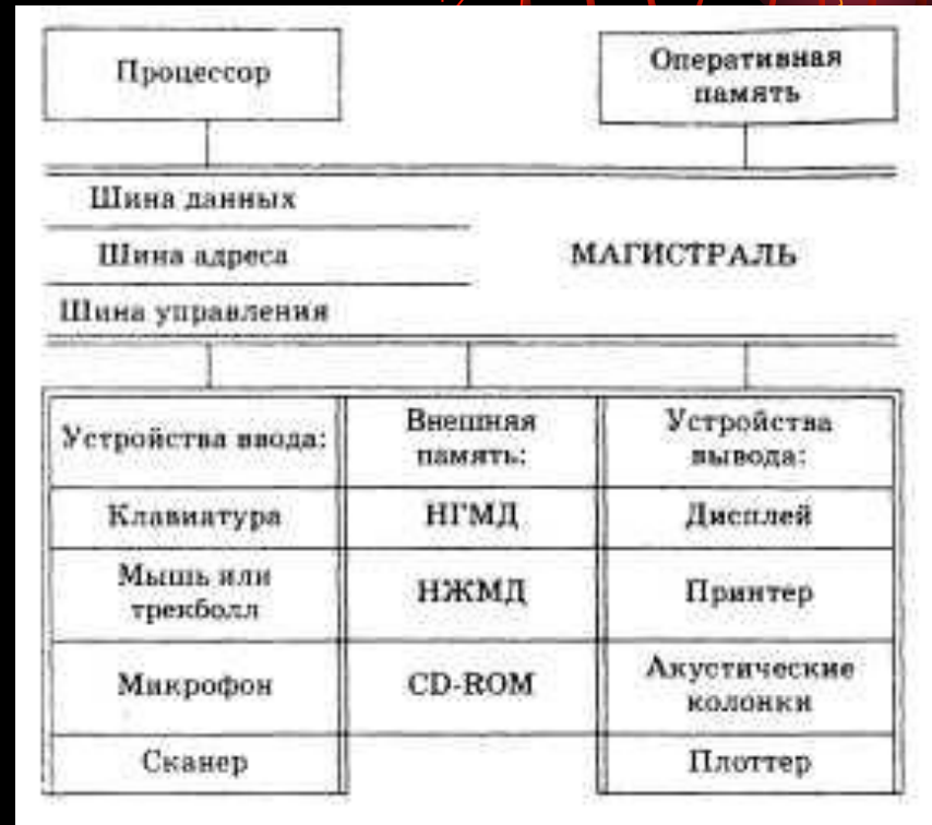
Схема магистрально-модульного принципа построения ПК
