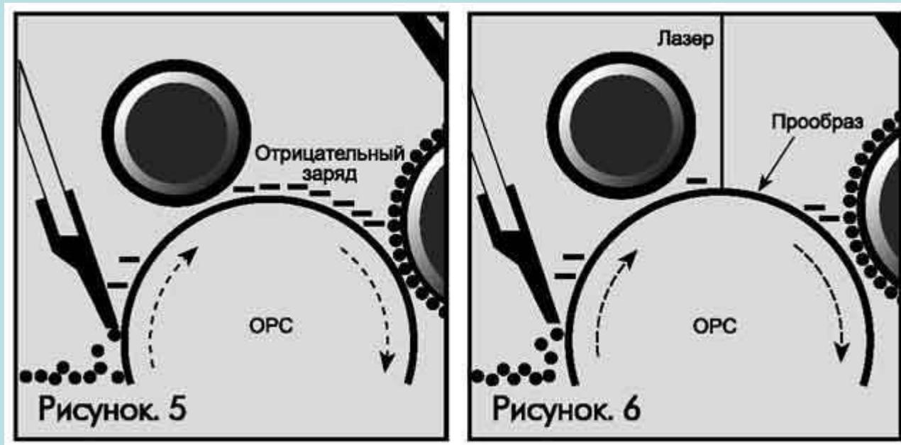
После отправки документа на печать, в картридже лазерного принтера происходят следующие процессы:
