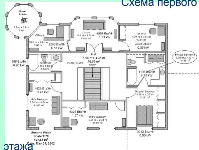
Схема второго этажа
