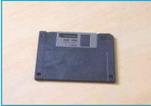
Дискета - портативный магнитный носитель информации, используемый для многократной записи и хранения данных сравнительно небольшого объема. Запись и считывание дискет
