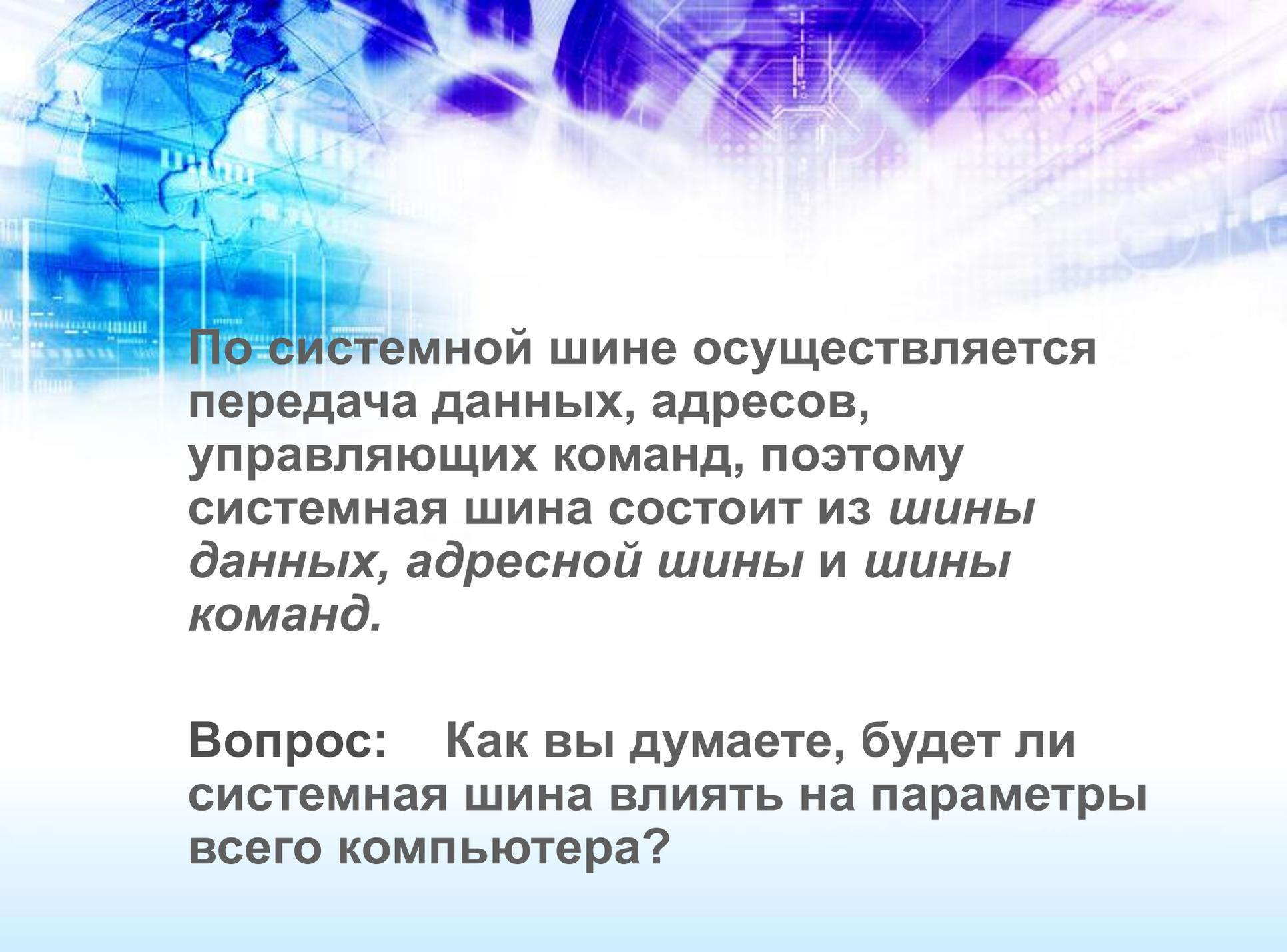
**По системной шине осуществляется передача данных, адресов, управляющих команд, поэтому системная шина состоит из *шины данных, адресной шины и шины команд*.**
