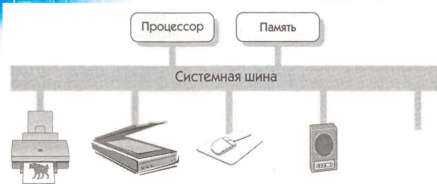
Системная шина – информационная магистраль, которая связывает друг с другом все устройства компьютера (группа токопроводящих кабелей или линий на системной плате)
