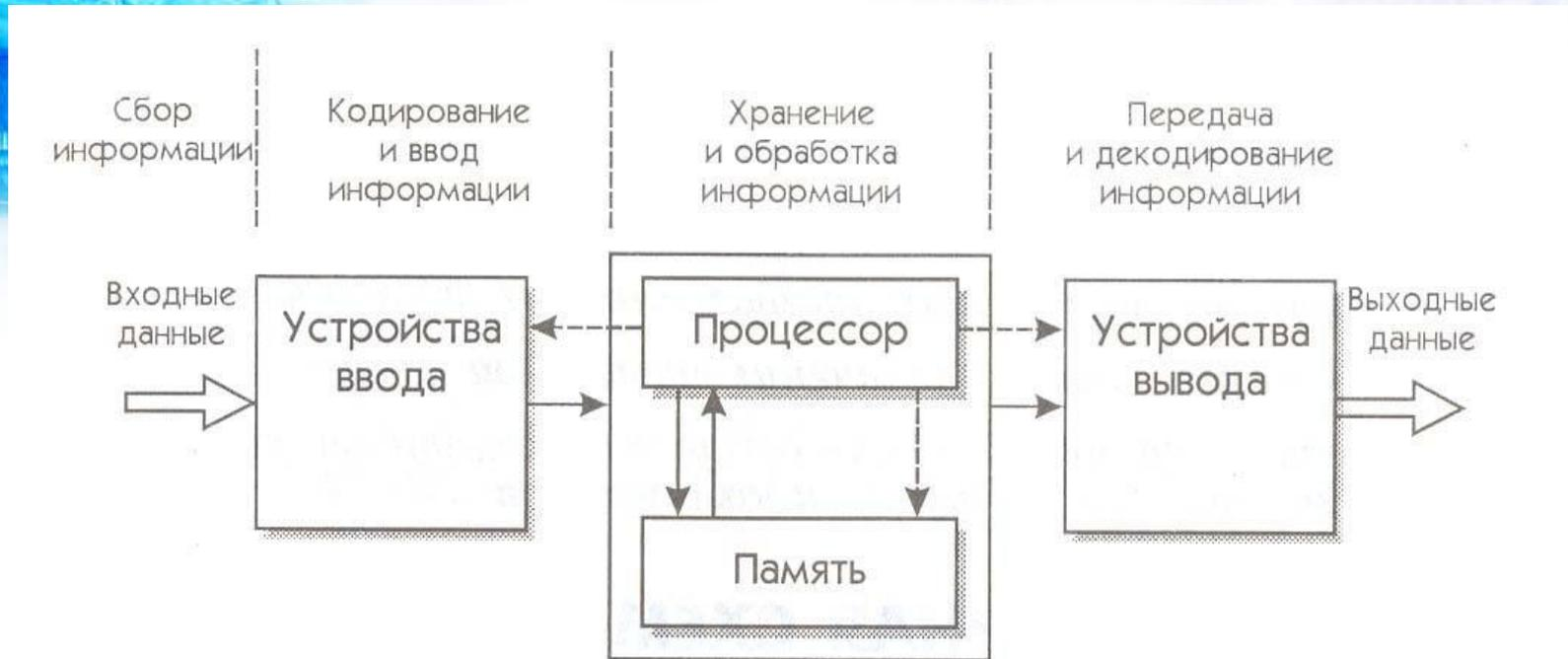
Каждое внешнее устройство взаимодействует с процессором ПК через специальный блок – **КОНТРОЛЛЕР**, который преобразует информацию, поступающую от процессора в соответствующие сигналы, управляющие работой устройства. Существуют контроллеры монитора, клавиатуры, принтера, дисководов...
