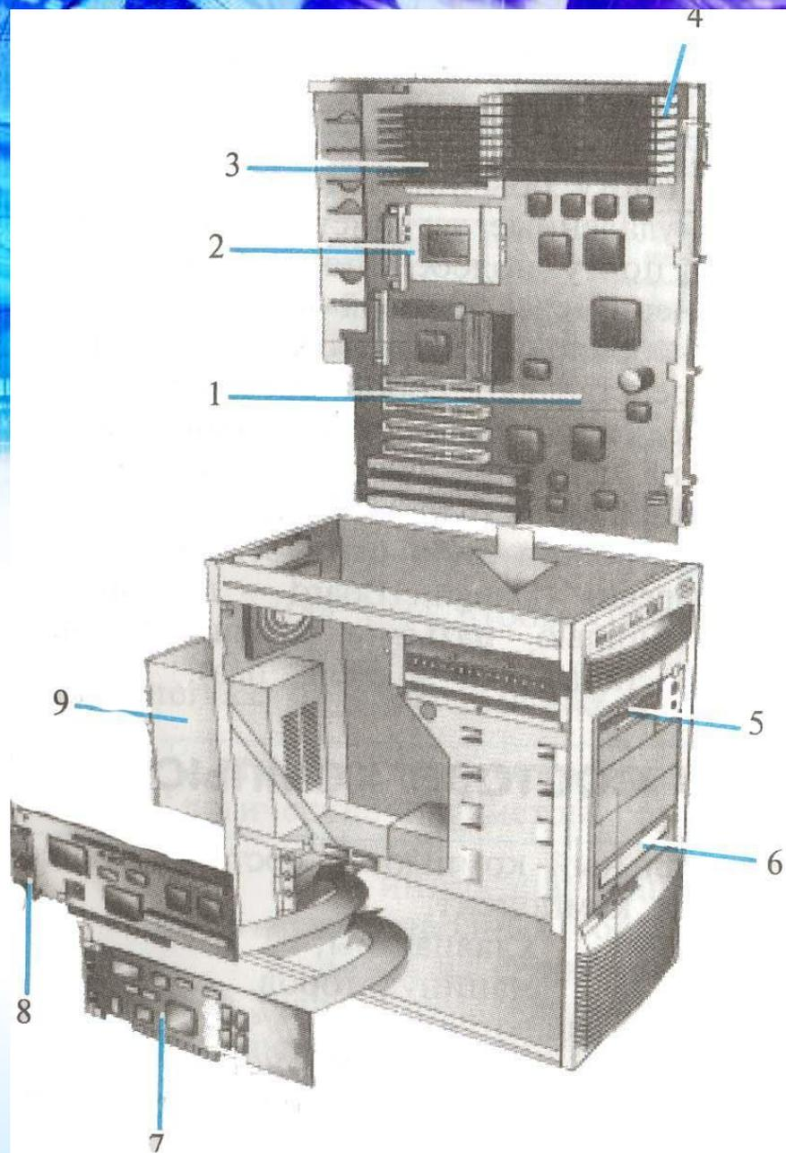
Системный блок со снятой крышкой:
