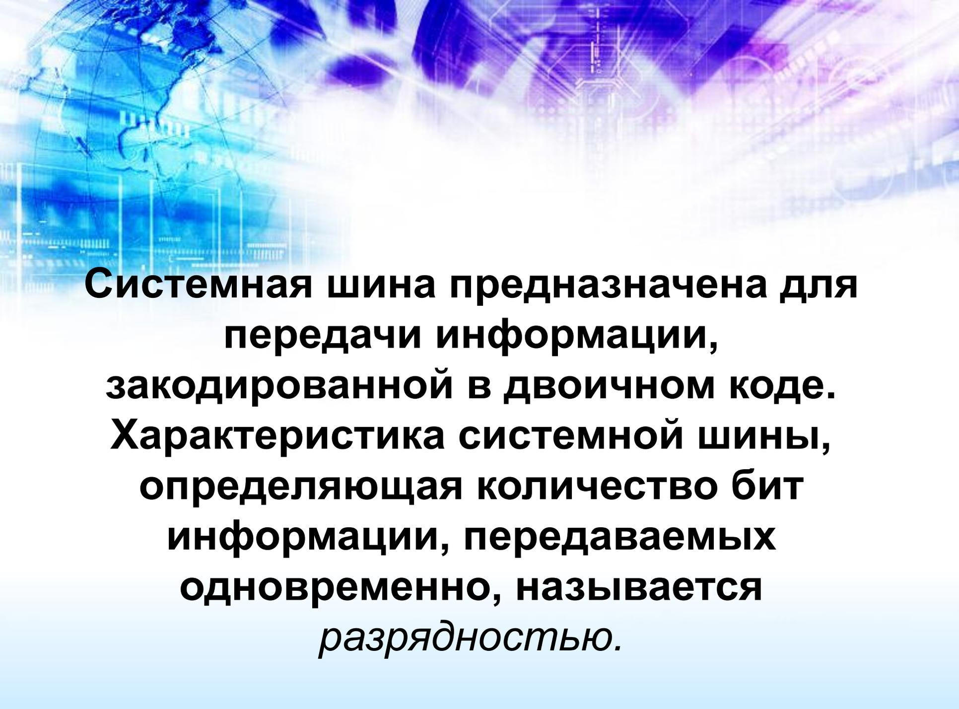
**Системная шина предназначена для передачи информации, закодированной в двоичном коде. Характеристика системной шины, определяющая количество бит информации, передаваемых одновременно, называется *разрядностью*.**
