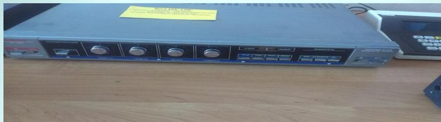
"Вега У-120-стерео", позднее "Вега 10У-120-стерео" полный усилитель 1 группы сложности. Он предназначен для усиления сигналов от различных источников звуковых программ. Модель имеет: коммутацию входов источников программ; регулировку АЧХ ВЧ(Высоких частот) и НЧ(Низких частот), громкости и стереобаланса; ступенчатое изменение громкости; включение фильтров ВЧ, НЧ; индикаторы сети и перегрузки. Габаритные размеры усилителя - 430x70x360 мм. Его масса 7 кг.
