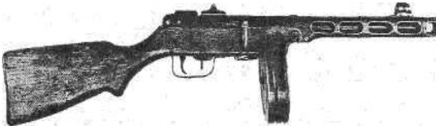
**7,62-мм пистолет-пулемет системы Шпагина образца 1941 г. ППШ-41.**
