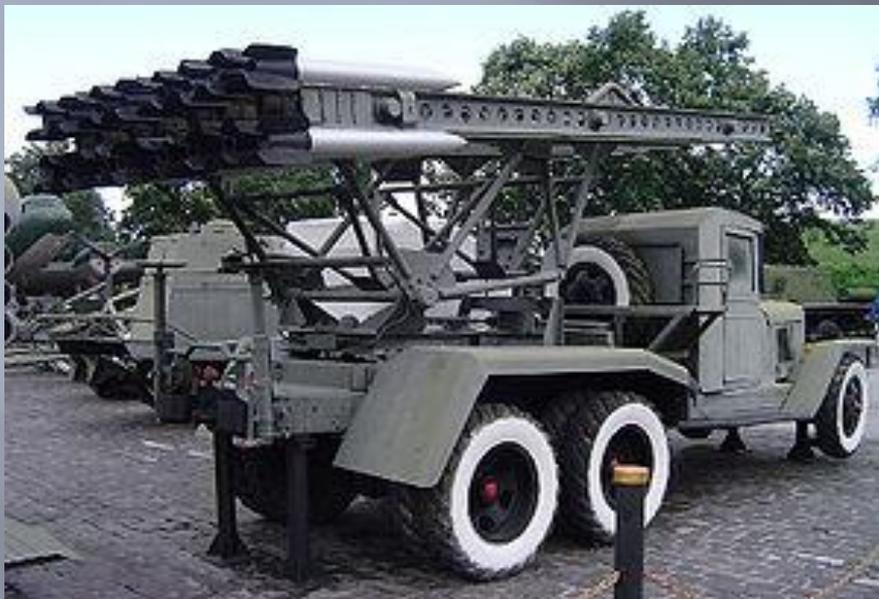
Оружие относительно простое, состоящее из направляющих рельсов и устройства их наведения. Для наводки были предусмотрены поворотный и подъёмный механизмы и артиллерийский прицел. В задней части машины находились два [домкрата](#), обеспечивающие бóльшую устойчивость при стрельбе.
