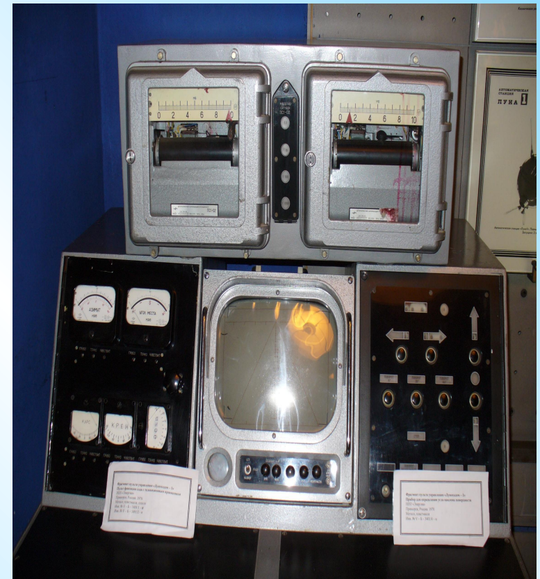
Пульт дистанционного управления Луноходом
