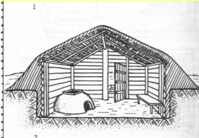
Полуземлянка. Изнутри обшита тесаными бревнами. Сверху полностью засыпана землей. Обогревается глиняной печью. Характерна для X–XI вв., для южных районов Руси.
