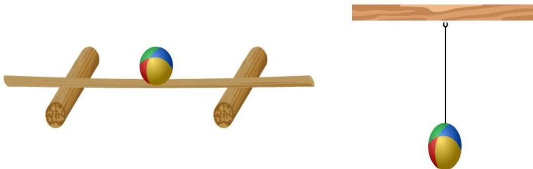
Рисунок 3.30. Пример действия тела на опору или подвес
