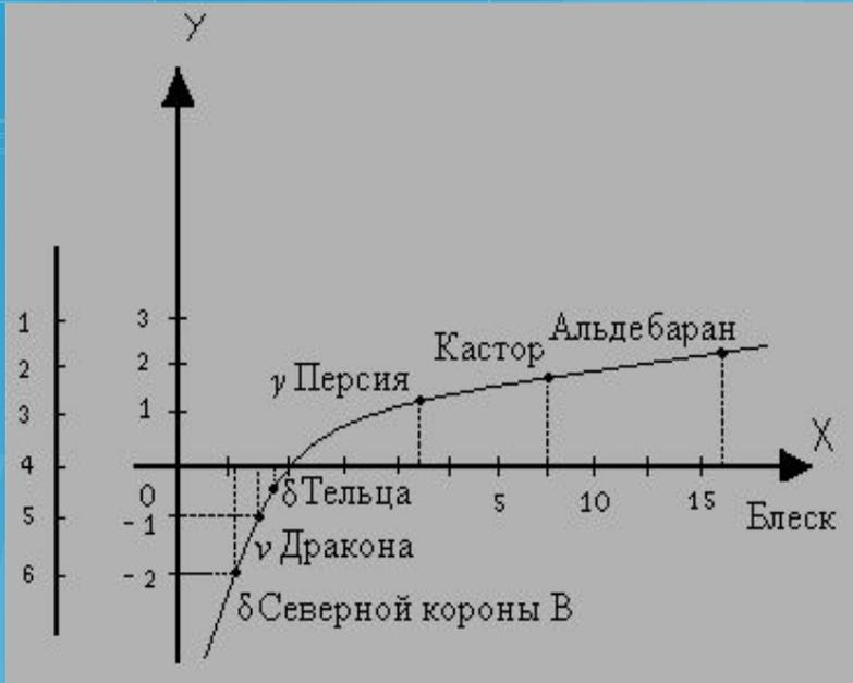
По вертикальной оси отложим блеск звезд в единицах Гиппарха (распределение звезд по субъективным характеристикам (на глаз) на 6 групп), а на горизонтальной - показания приборов.
