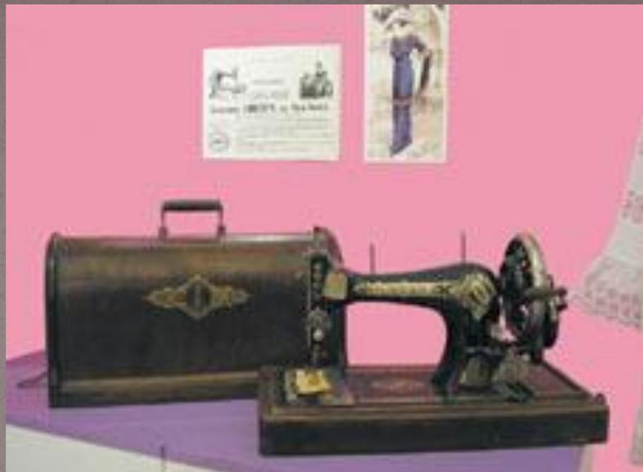
*Швейная машина челночного стежка для стачивания тканей (подольский завод компании "Зингер", 1905-1920). Ее корпус имеет так называемую бутылочную форму, которая была запатентована фирмой "Зингер" в конце XIX века. Благодаря сбалансированности всех конструктивных узлов такие машины обладают большим запасом прочности и до сих пор используются во многих домах России.*
