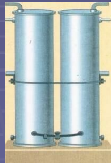
Вертикальный бак аварийного запаса воды
