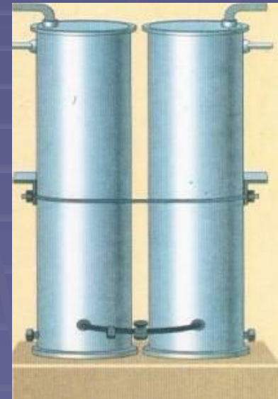
Вертикальный бак аварийного запаса воды
