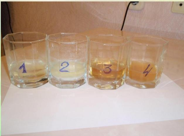
3. На седьмой день раствор в стакане 4 стал мутно-ржавый, гвоздь не просматривался, в стакане 3 гвоздь сильно поржавел, раствор окрасился в ржавый цвет. В стакане 1 гвоздь поржавел, но не сильно, во 2 стакане гвоздь не поржавел.
