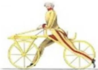
**Die Draisine:** zweirädriges Fahrzeug, Vorläufer des Fahrrads, mit dem sich der darauf Sitzende, sich mit den Füßen abstoßend, fortbewegt; kleines Schienenfahrzeug zur Kontrolle von Eisenbahnstrecke.
