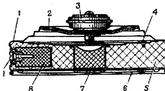
**1 – корпус; 2 – щиток; 3 – взрыватель МВЗ-57; 4 – диафрагма; 5 – заряд; 6 – дно; 7 – центральный дополнительный детонатор; 8 – боковой дополнительный детонатор; 9 – пробка**
