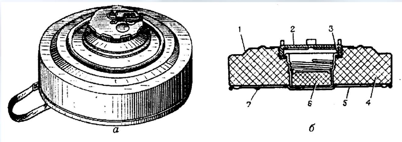
1 – корпус; 2 – пробка; 3 – прокладка; 4 – заряд; 5 – дно; 6 – дополнительный детонатор; 7 – проушина для крепления ручки
