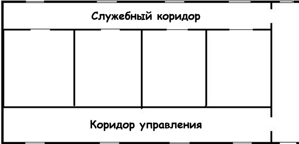
**А) Вход в кабинки из служебного коридора, кабинки изолированы от коридора управления**
