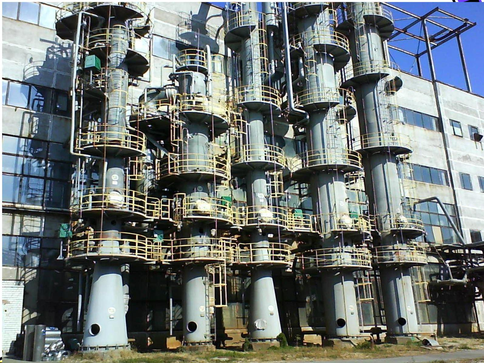
**Наружные установки (колонны ректификации) на производстве акриловых соединений**
