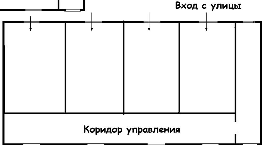
**Б) Коридор управления не соединен с кабинками, вход в кабинки осуществляется с улицы**
