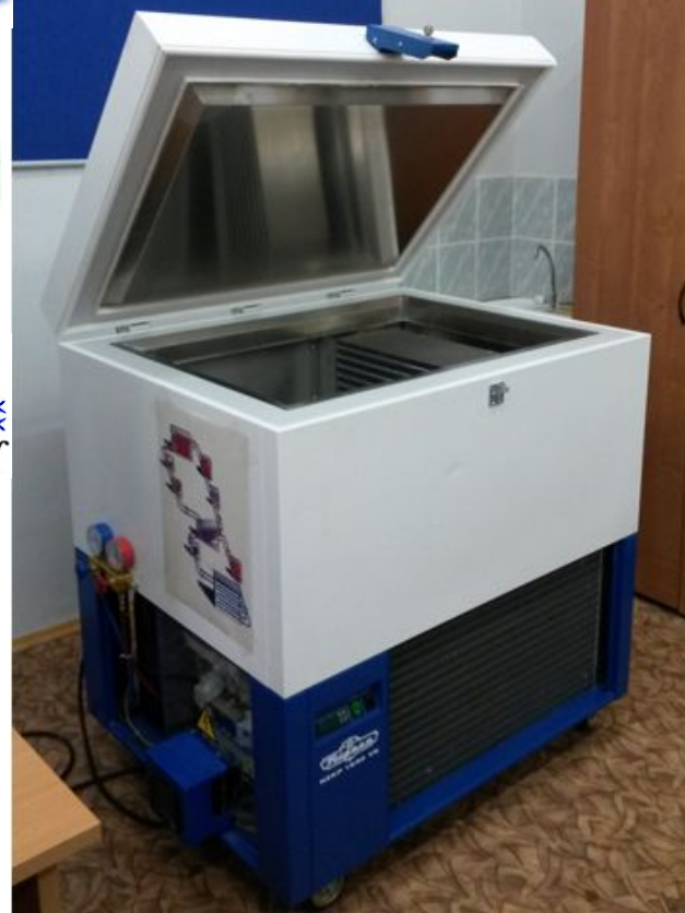
Каскадная холодильная машина обеспечивает температуру в камере до -80^{\circ}\text{C}
