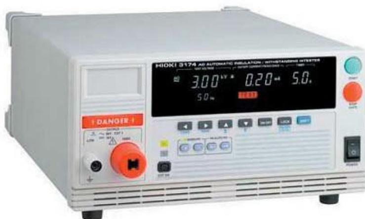
Модель объединяет в себе два прибора: прибор для измерения сопротивления изоляции и прибор для проверки электрической прочности изоляции (испытание изоляции на пробой):
