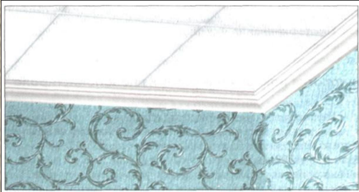
Стык между кромкой обоев стены и потолочными плитами можно закрыть карнизами, которые изготавливаются из пенополистирола. Наклеивают карнизы в последнюю очередь, после отделки стен и потолков.
