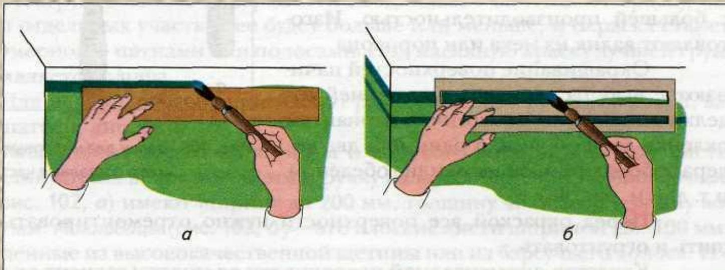
Отводка филенок: а — по линейке; б — по трафарету
