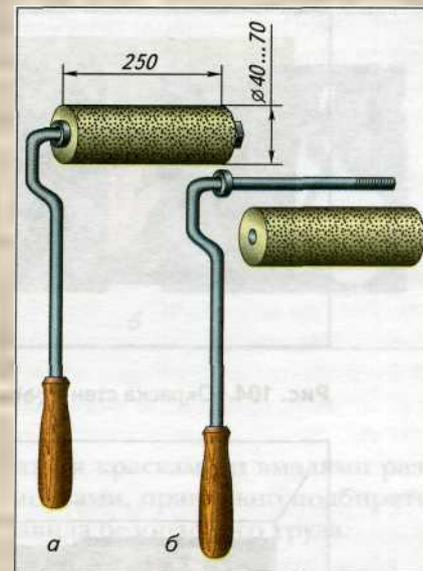
Валик для малярных работ (а) и его составные части (б)
