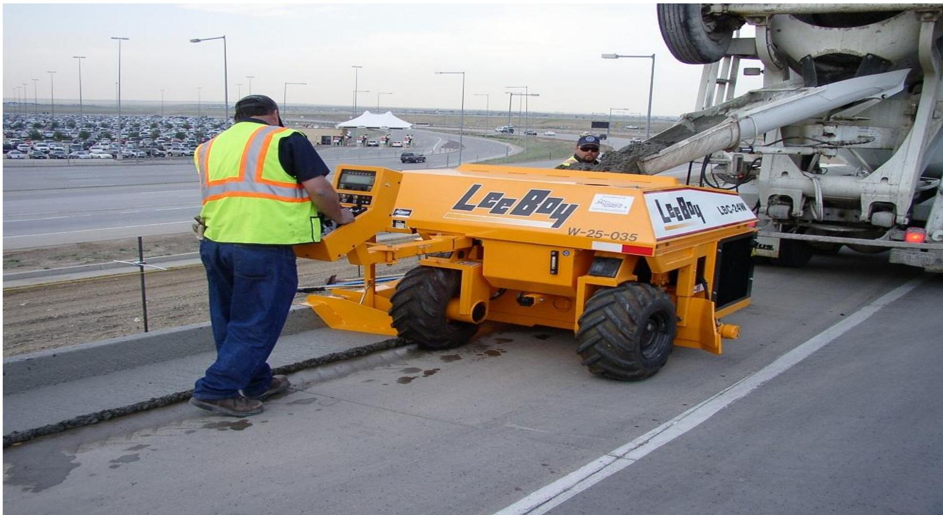
Компактная и маневренная машина **LeeBoy LBC-24W** позволяет с высокой скоростью и качеством изготавливать бордюрный камень или водосточный желоб. Кроме этого, специальные легкозаменяемые скользящие опалубки позволяют формировать узкие дорожки и тротуары шириной до 1,2 м. Рулевое управление позволяет выполнять плавные закругления радиусом до 61 см, что значительно экономит время на ручное формирование.
