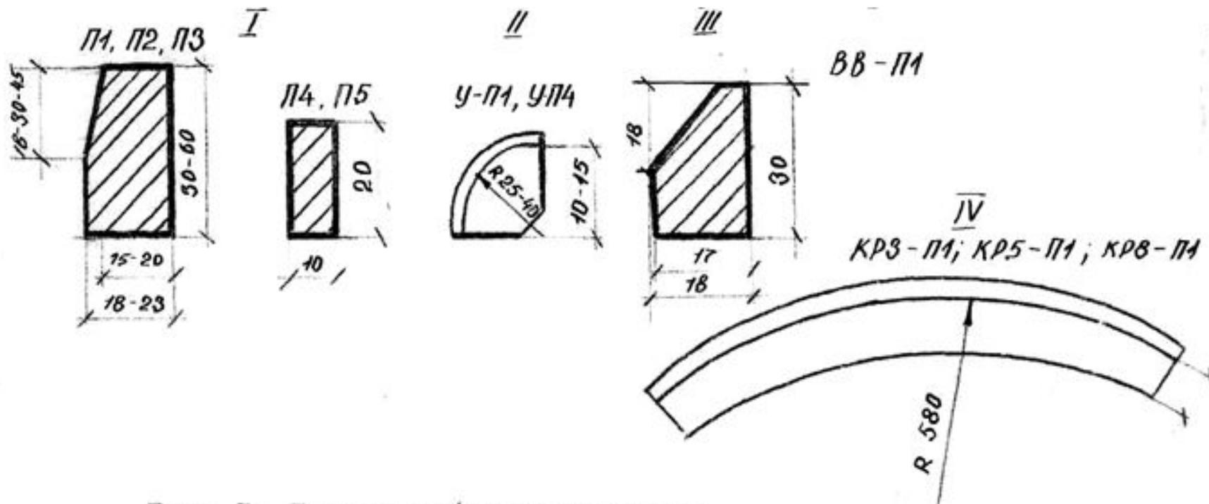
Рис. 1. Бетонные бортовые камни:
