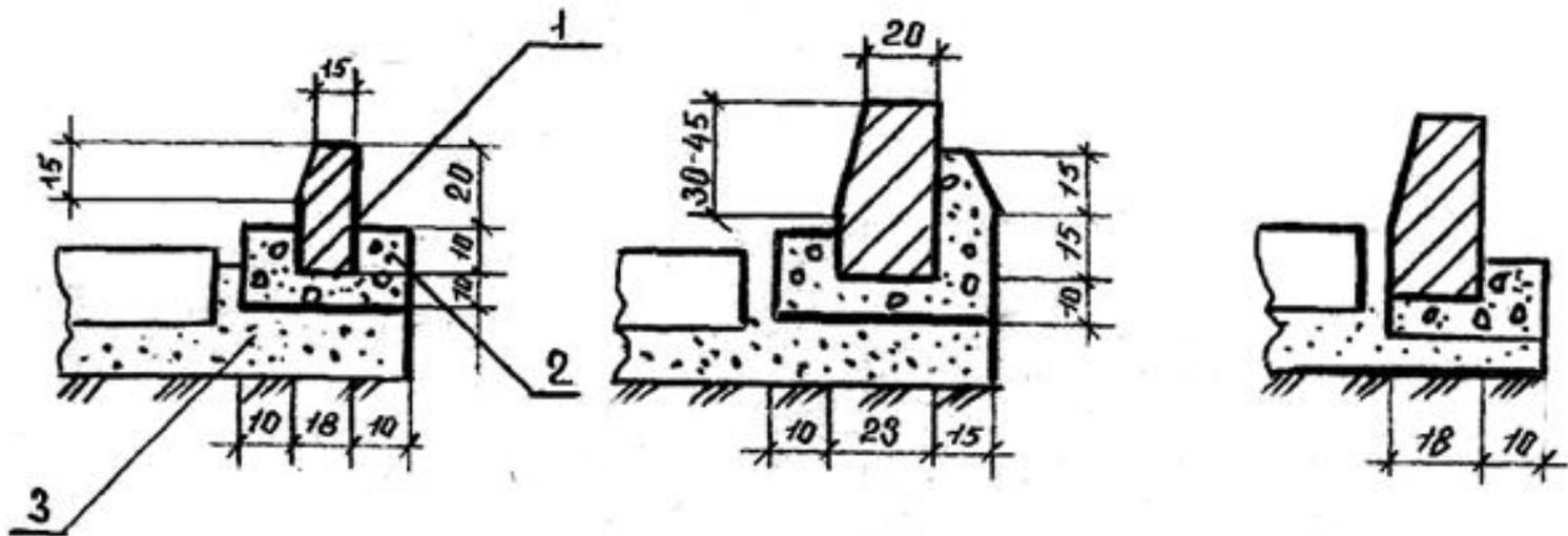
Рисунок №3. Способы установки бортовых камней:
