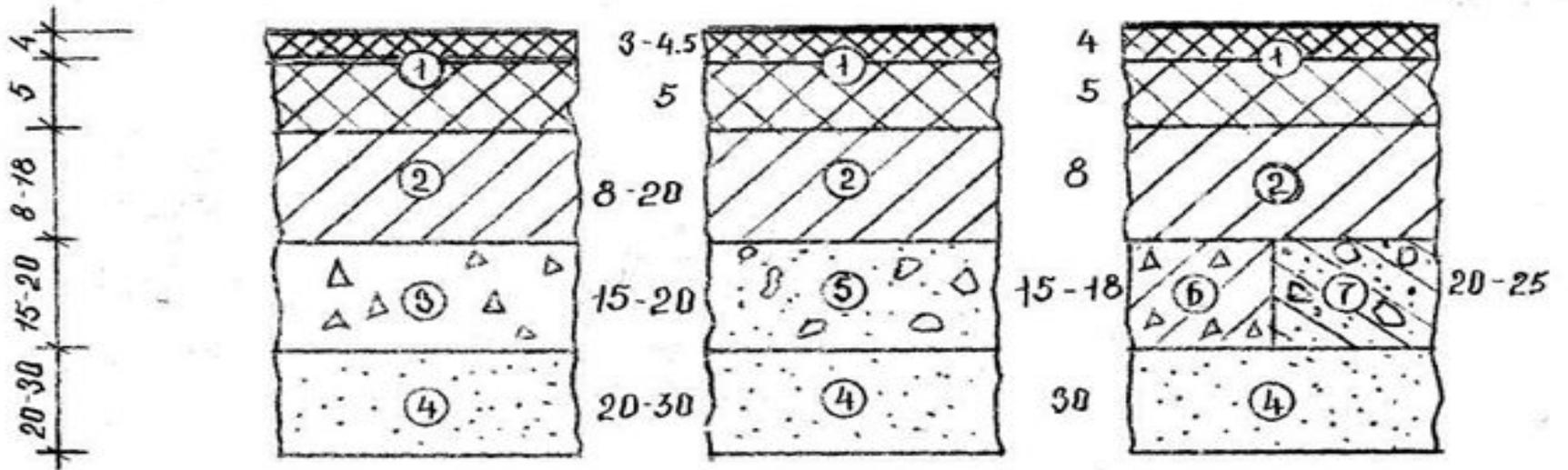
Рис.5. Конструкции дорожных одежд.
