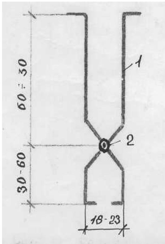
Рис, 2. Конструкция металлических клещей для установки бортового камня.
