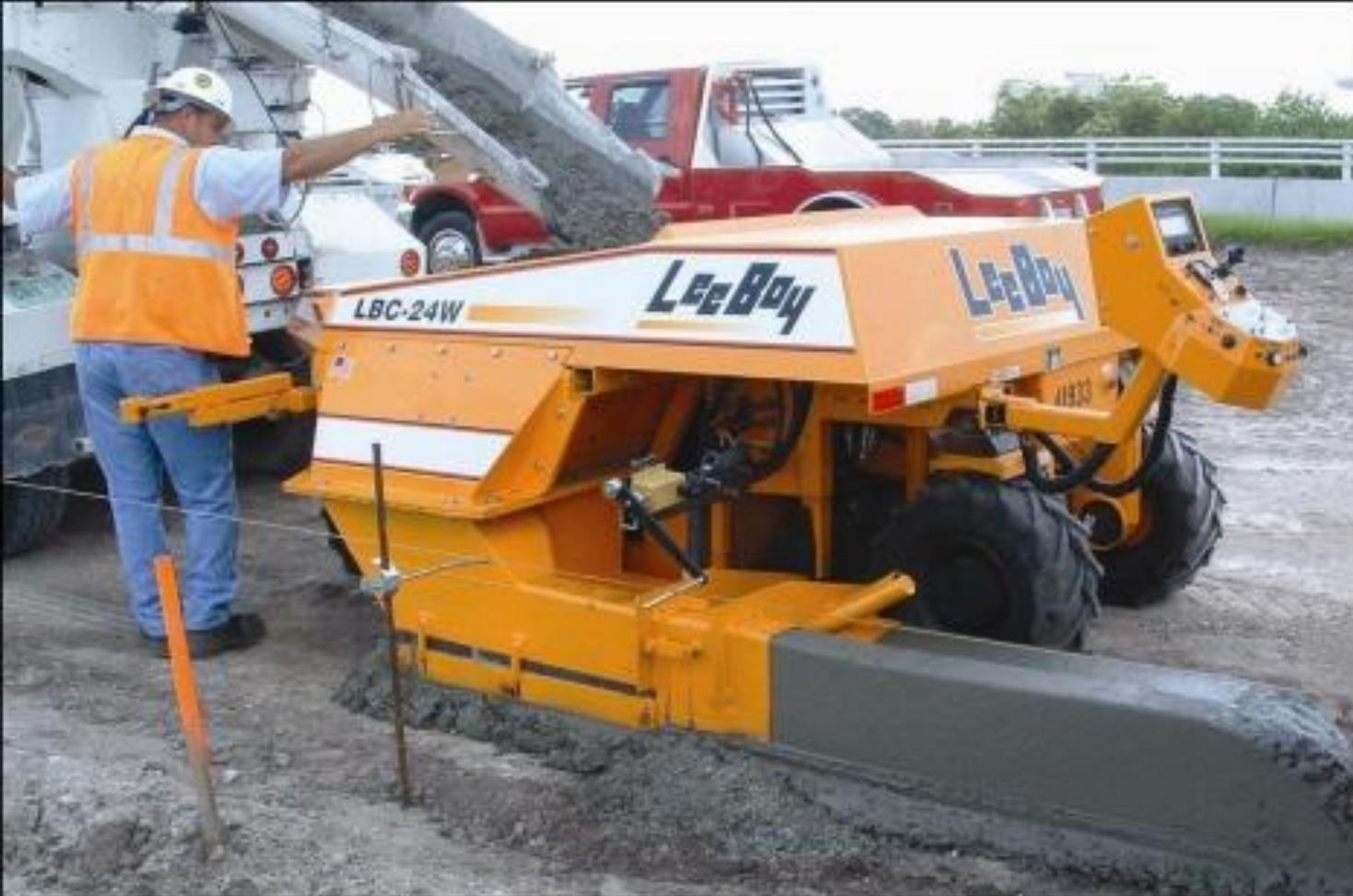
Компактная и маневренная машина **LeeBoy LBC-24W** позволяет с высокой скоростью и качеством изготавливать бордюрный камень или водосточный желоб. Кроме этого, специальные легкозаменяемые скользящие опалубки позволяют формировать узкие дорожки и тротуары шириной до 1,2 м. Рулевое управление позволяет выполнять плавные закругления радиусом до 61 см, что значительно экономит время на ручное формирование.
