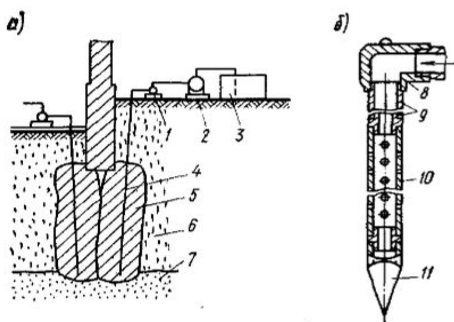
**V.9. Схема установки для химического закрепления грунтов**
