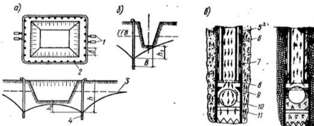
**V.4. Схема размещения инфильтровых установок**
