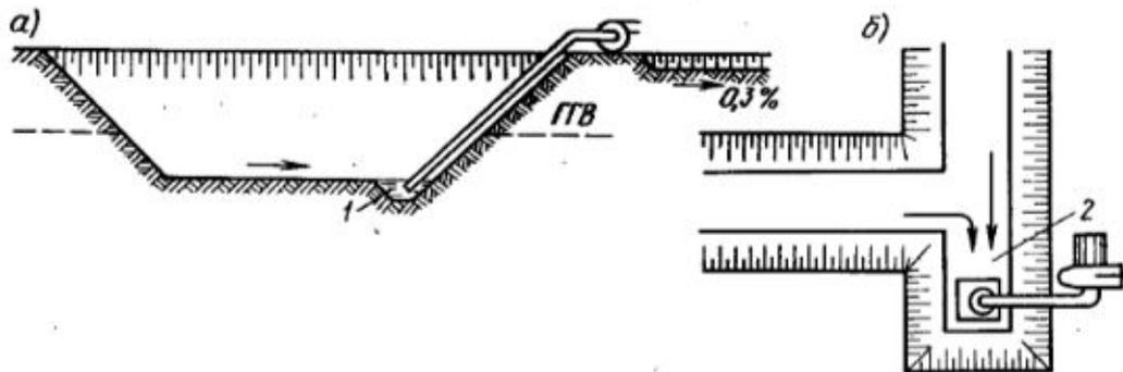
**V.3. Схема открытого водоотлива**
