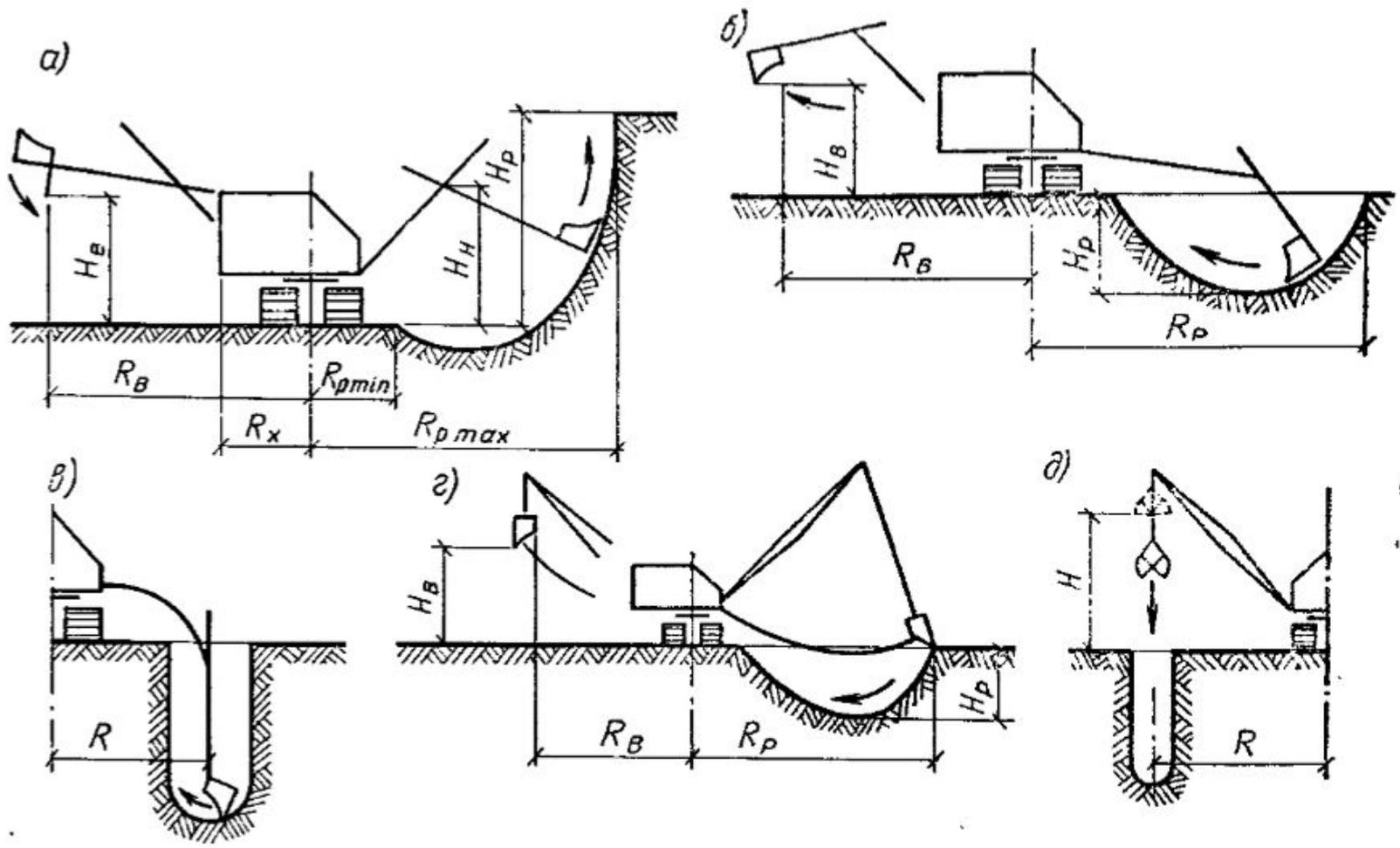
**V.16. Схемы рабочих параметров одноковшового экскаватора**
