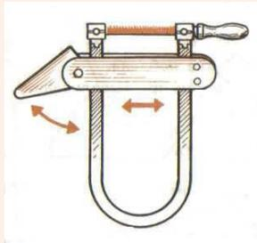
Для стягивания рамки перед креплением пилки применяют эксцентриковый зажим. После закрепления пилки винтами эксцентриковый зажим снимают. Пилка под действием рамки натягивается.
