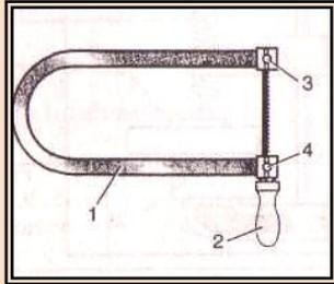
Пропильную резьбу на фанере обычно выпиливают лобзиком, который состоит из рамки с ручкой, верхнего и нижнего зажимных винтов. Между зажимными винтами натягивается и крепится узкая и тонкая стальная пилка с наклоном зубьев в сторону ручки.
