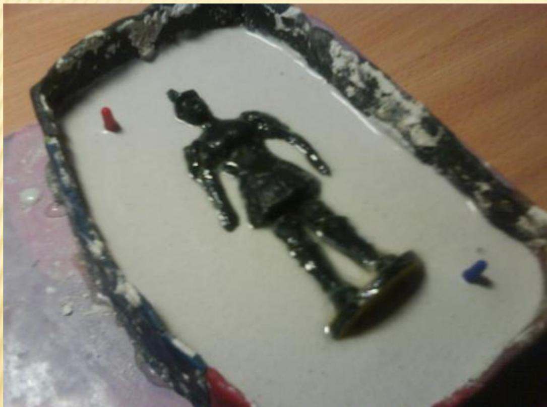
Выливаем полученный раствор в сделанную коробочку, приблизительно на половину высоты бортиков. Опускаем туда модель до половины и делаем замки-конусы справа и слева от фигурки.
