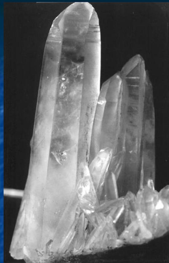
Кристаллы сыграли важную роль во многих технических новинках 20 в. Некоторые кристаллы генерируют электрический заряд при деформации. Первым их значительным применением было изготовление генераторов радиочастоты со стабилизацией кварцевыми кристаллами. Заставив кварцевую пластинку вибрировать в электрическом поле радиочастотного колебательного контура, можно тем самым стабилизировать частоту приема или передачи.
