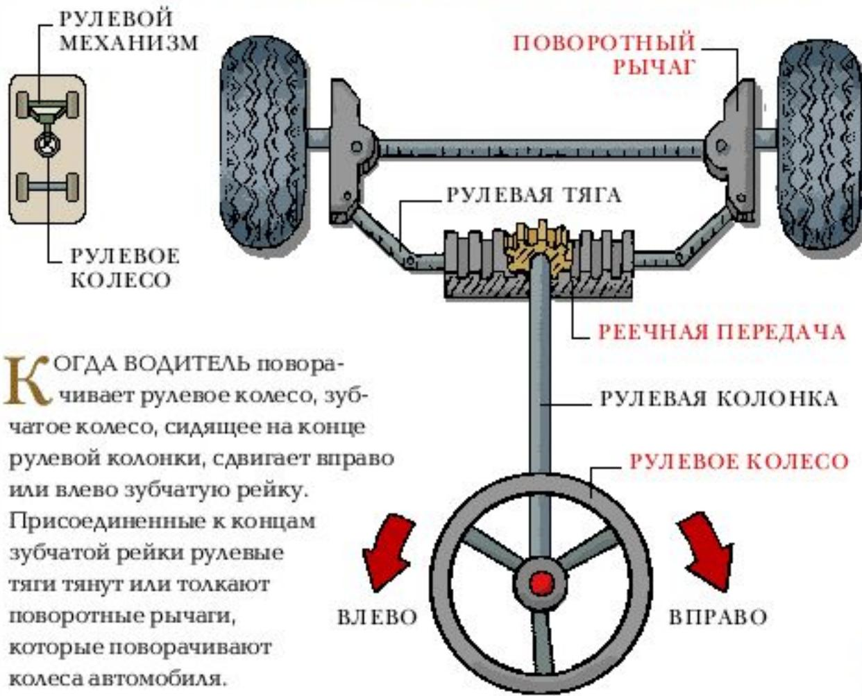
**К**ОГДА ВОДИТЕЛЬ поворачивает рулевое колесо, зубчатое колесо, сидящее на конце рулевой колонки, сдвигает вправо или влево зубчатую рейку. Присоединенные к концам зубчатой рейки рулевые тяги тянут или толкают поворотные рычаги, которые поворачивают колеса автомобиля.
