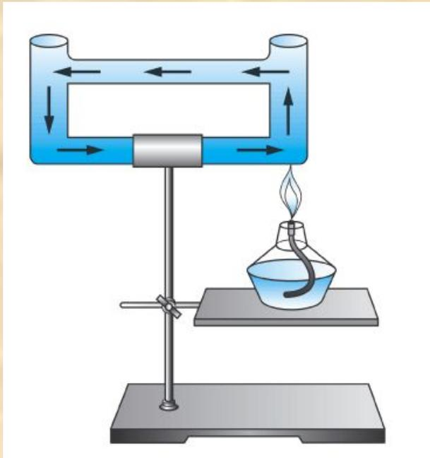
***Жидкости и газы нагревают снизу, так как у них плохая теплопроводность и теплообмен происходит за счёт конвекции.***
