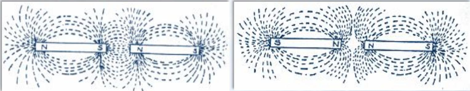
2. Магнитные линии – замкнутые линии. Вне магнита магнитные линии выходят из «N» и входят в «S», замыкаясь внутри магнита.
