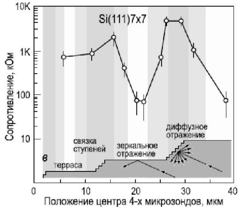
«Профили» сопротивления на поверхностях б -  $\text{Si}(111)3^{1/2} \times 3^{1/2}\text{-Ag}$ ; в -  $\text{Si}(111)7 \times 7$ , измеренные с помощью микрозондов (расстояние между зондами 8 мкм) поперек макроступеней. Морфология поверхности образцов изображена схематически в нижней части графиков. Сопротивление, измеренное поперек ступени, много выше, чем измеренное на террасе без ступеней.
