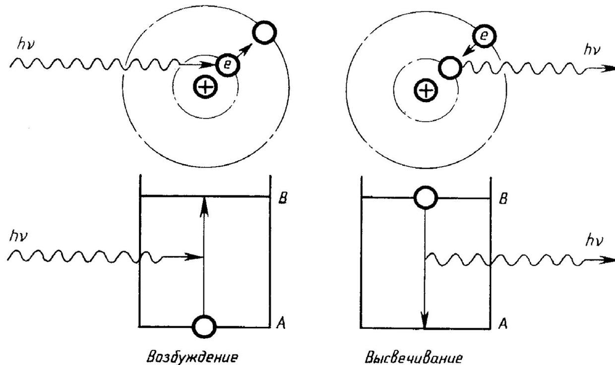
В 1917 г. А. Эйнштейн предсказал возможность перехода атома с высшего энергетического состояния в низшее под влиянием внешнего воздействия. Такое излучение называется **вынужденным излучением** и лежит в основе работы **лазеров**.
