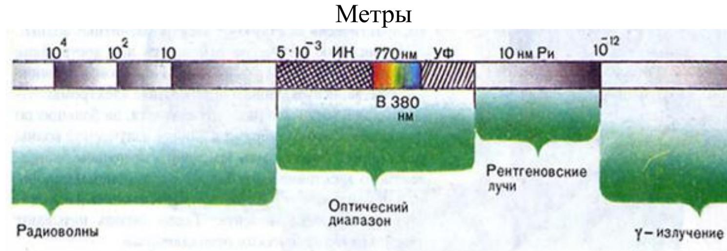
**Радиоволны**—это электромагнитные волны (с длиной волны от более чем  $10000$ м до  $0,005$ м), служащие для передачи сигналов (информации) на расстояние без проводов. В радиосвязи радиоволны создаются высокочастотными токами, текущими в антенне. Радиоволны различной длины распространяются по-разному.
