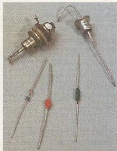
Простейший полупроводниковый прибор — диод.
