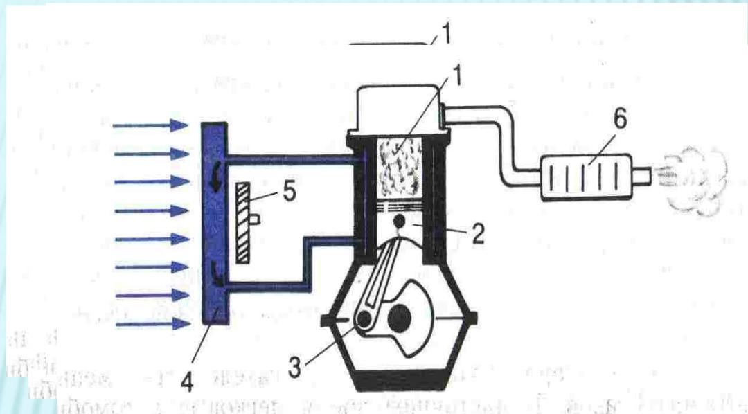
Схема двигателя внутреннего сгорания.
