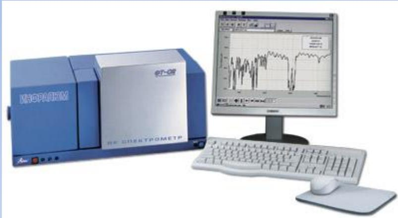
ИнфралЮМ ФТ-02 - универсальный Фурье-спектрометр среднего ИК-диапазона для лабораторного применения, снабженный системой сбора и обработки данных на базе персонального компьютера и пакетом аналитических программ.
