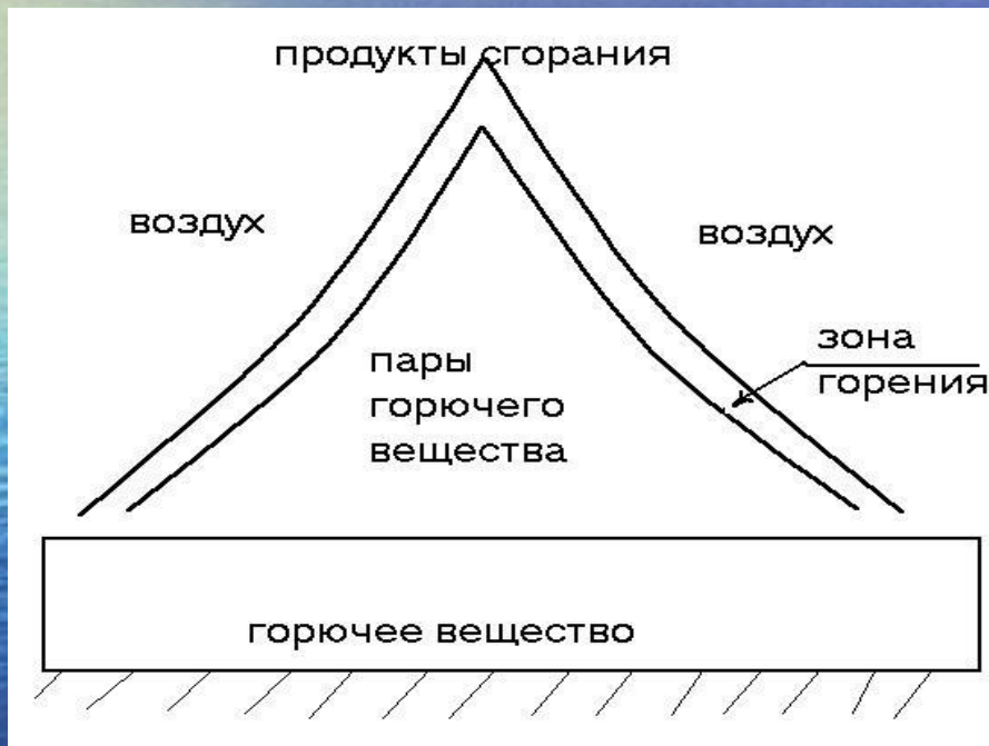
Рис. Строение ламинарного пламени
