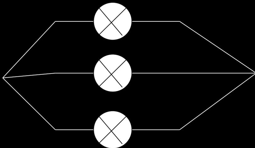
Благодаря этому соединению если перегорает одна лампочка,
