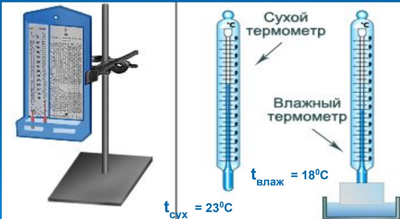
По разнице температур сухого и влажного термометров и температуре сухого термометра устанавливают влажность воздуха по *психрометрической таблице*.
