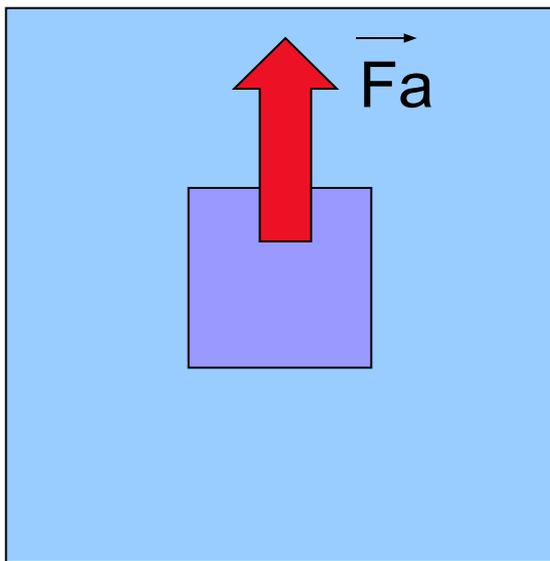
На тело, погружённое в жидкость, действует выталкивающая сила, направленная вверх и равная по модулю весу жидкости, вытесненной телом
