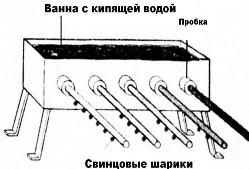
Прибор для сравнения теплопроводности
