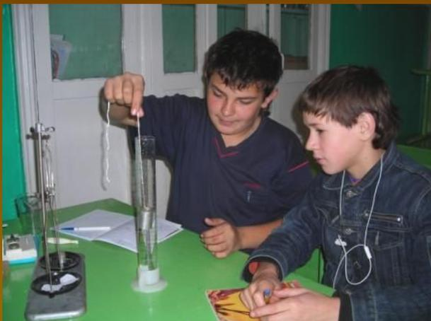
Пользуясь методом Архимеда, мы определили объем цилиндра, опустив его в мензурку с водой.
